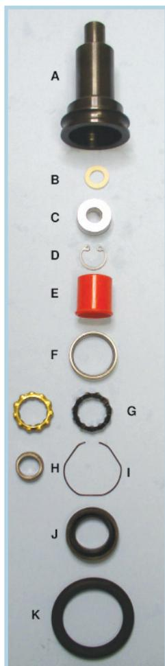
**Recuperação da caixa de rolamentos:** O conjunto usado é desmontado, limpo e inspecionado. A Epic sempre substitui a arruela retentora de feltro (B), o rolamento de agulhas superior (C), a bucha distanciadora de nylon (E), o anel deslizante externo (F), a gaiola do rolamento (G) e o anel retentor de arame (I). Todas as peças estáticas que apresentam desgaste ou defeitos também devem ser substituídas. O conjunto recuperado é lubrificado com graxa sintética Klüber.
