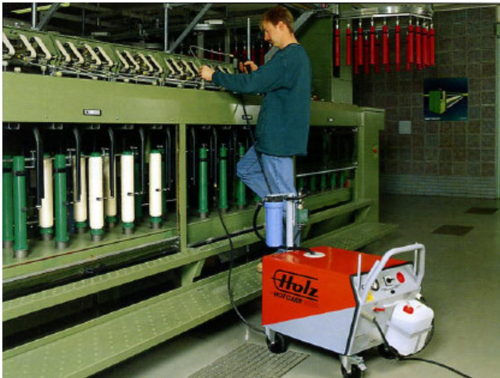
A HOLZ fornece um tipo de lavador chamado de HOT CLEAN H20, que trabalha com temperatura de aproximadamente 85°C e pressão de 4 a 7 bar.
